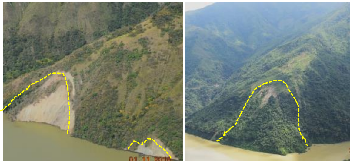
Figura 13-12: Derrumbe reciente en ladera izquierda y antiguo derrumbe en ladera derecha, aguas arriba del sitio de presa; fotos tomadas desde un helicóptero. Corresponden a deslizamientos activos, a partir de estos deslizamientos primigenios, se ha visto desarrollarse y hacerse más grandes con respecto a su inicio.
