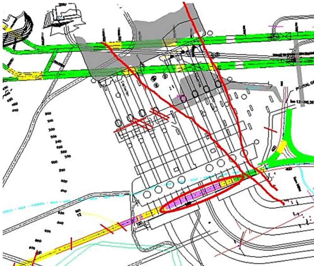
Figura 13-18: Levantamiento de grietas, realizado por ONU/SDC (2018)
